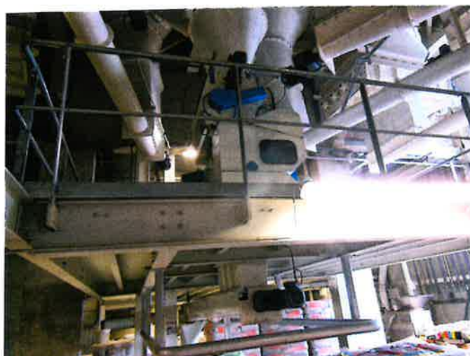
L'usine compte un concasseur à maïs permettant de produire du mash.
