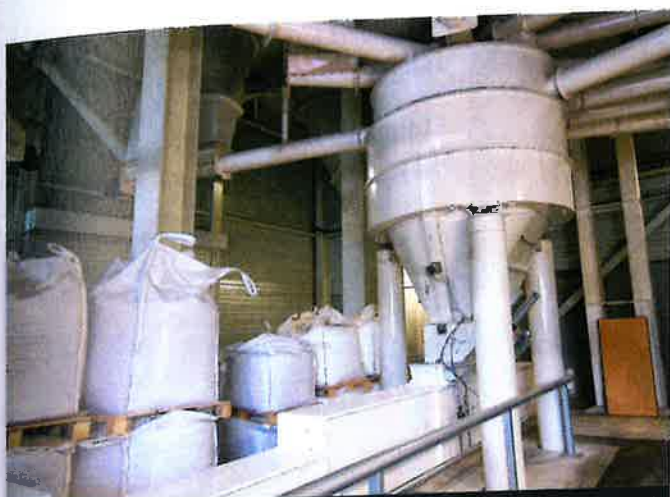
Les matières premières arrivent dans deux bennes doseuses permettant un gain de temps pour les fabrications.
